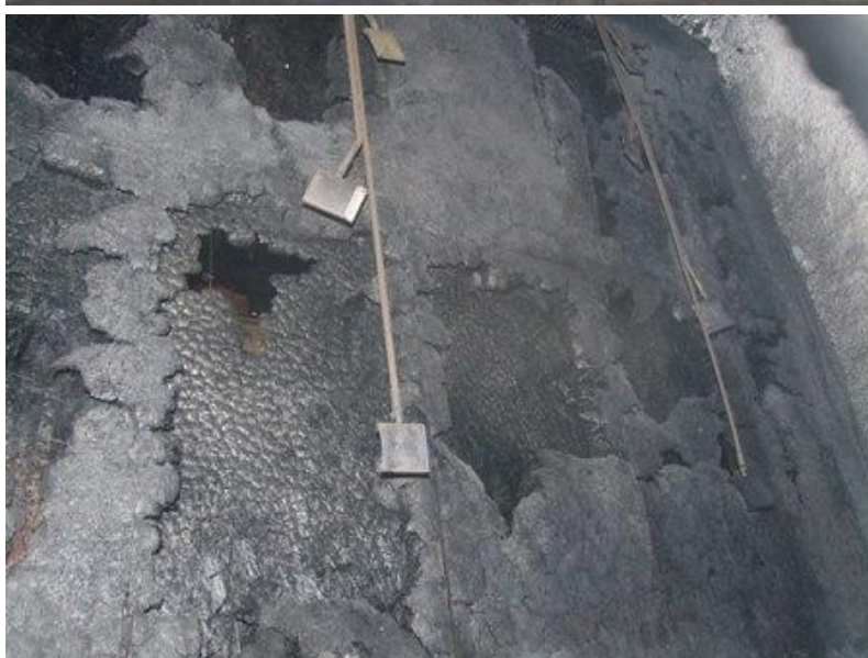
Ohrievaná strana vzorky po ukončení skúšky
